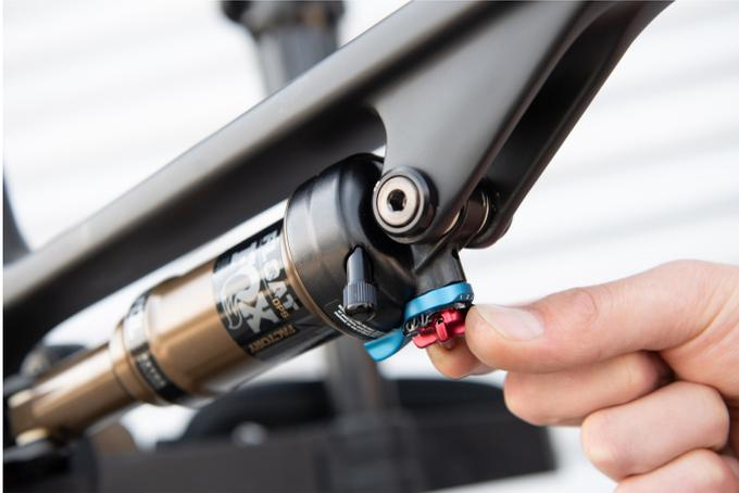
Abb. 29: Hinterbaudämpfer Zugstufe
