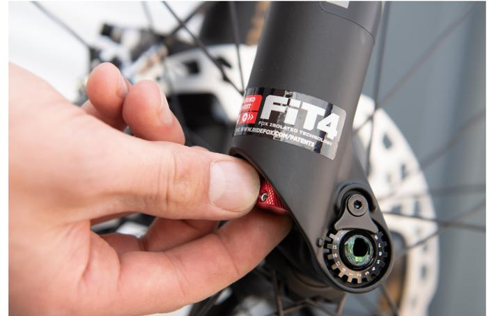
Abb. 27: Federgabel Zugstufe
