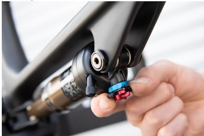
Abb. 28: Hinterbaudämpfer Druckstufe
