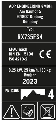
Abb. 1: Typenschild beispielhaft für ein ROTWILD Bike
