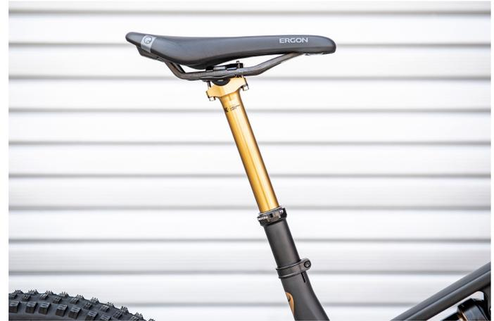
Abb. 25: Sattelstütze
