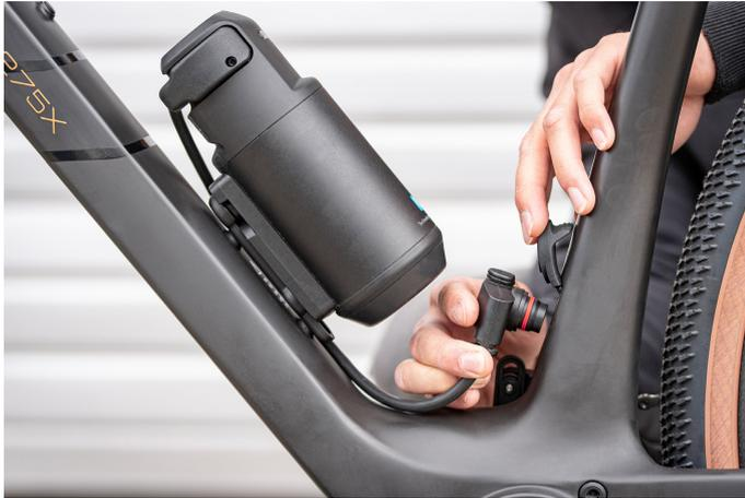
Abb. 16: TQ Range Extender am R.R275X
