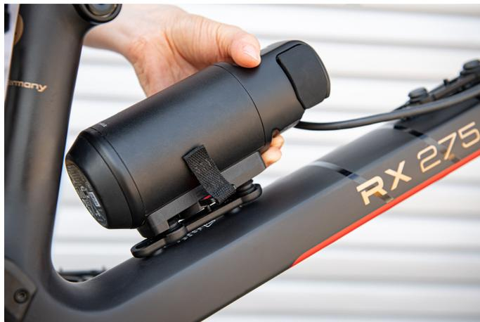
Abb. 15: TQ Range Extender am R.X275
